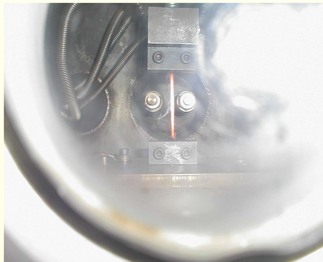
Carbon-Fasern im Zugversuch bei 1400°C
